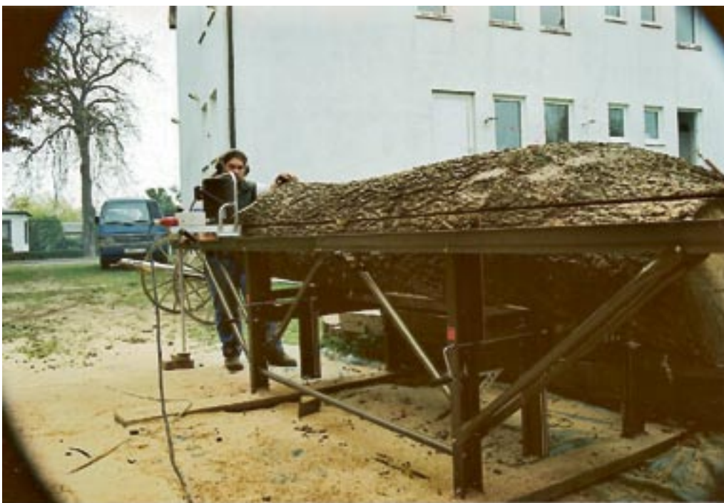
Der erste Schnitt, das Abtrennen der Schwarte - ein Schnitt genau durch den Kern. Das Hantieren mit den Stämmen zur schonenden und präzisen Auflage der Stämme von der Rampe auf das Logosol dauerte zu dritt je eine Stunde. Vom Elektroaufsatz musste die Schutzvorrichtung entfernt werden.
