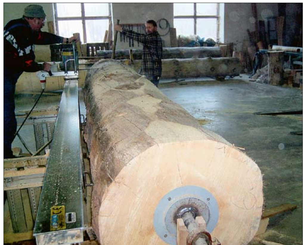
Mit einer zusätzlich gebauten Halterung, um den Stamm wie beim Drechseln drehen zu können, gelang es Gunter Storch (links) und seinem Kollegen Peer Seelvo das Fichtenholz mit Hilfe der M5 keilförmig zu schneiden.
