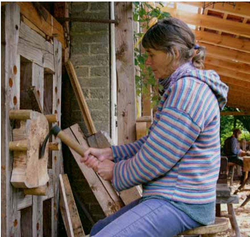
Wird der Stuhlsitz senkrecht auf der Spannwand verkeilt, arbeitet es sich entspannter.
