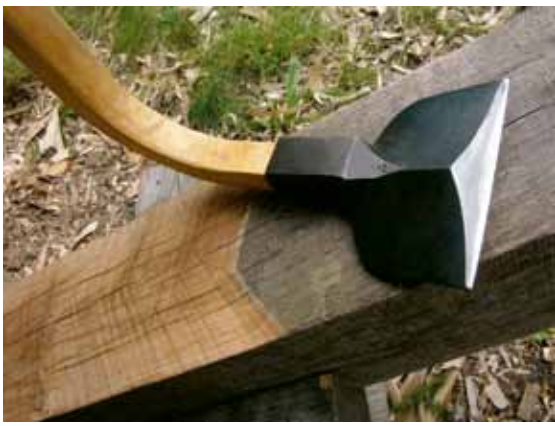
Der krumm gewachsene Stiel des Chona, wie der Dechsel in Japan genannt wird, federt beim Schlag und erzeugt ein ganz eigenes Schnittbild. Dies wird bevorzugt im Fischgrätmuster gehauen.
