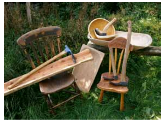
Stuhlsitze, Schalen aller Art und Regenrinnen sind typische Schnitzarbeiten für Hohldechsel. Wer es noch größer mag, kann sich an einem Einbaum versuchen.
