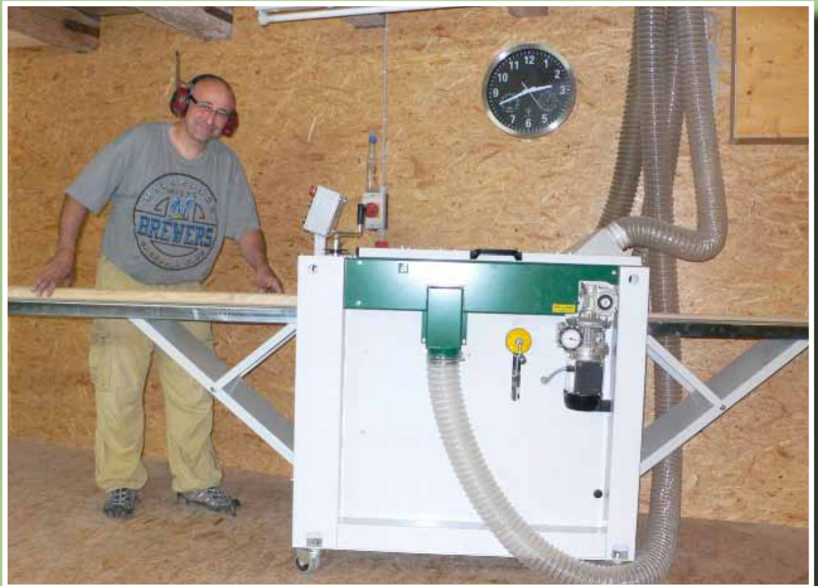
• Unverzichtbar beim Herstellen von Blockintarsien: der Vierseitenhobel PH 260.
