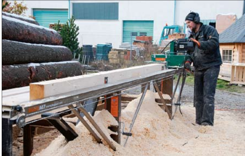
Die mit der Logosol Blockhausfräse M7 geschnittenen Blöcke werden jetzt mit dem Logosol Bandsägewerk LM 40 gehobelt.
